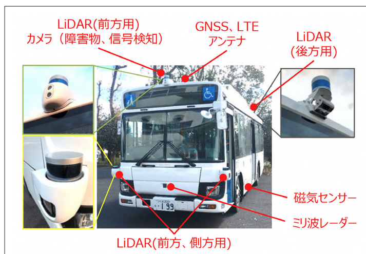
自動運転の実証実験(センシング装置) 出典:中型自動運転バスの実証実験の概要(国土交通省)
